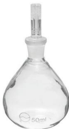
شکل ۱- نمای کلی از یک پیکنومتر کوچک رایج با درپوش شیشه‌ای
