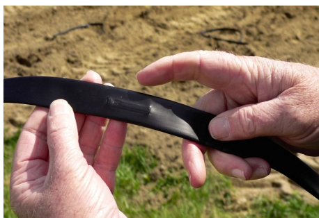
شکل 1- نمونه‌ای از لوله آبدی در سامانه آبیاری قطره‌ای زیر سطحی با آبدی به صورت قطره‌ای (وایت، 2017)
