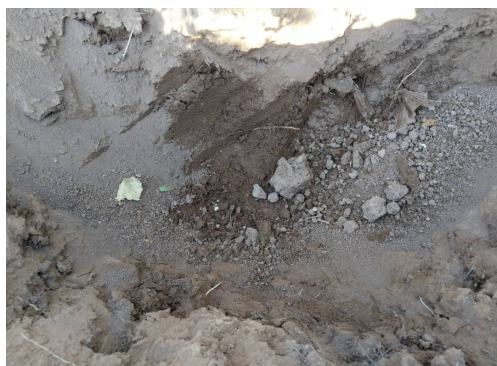
شکل 26- نمونه‌ای از پایش رطوبت خاک سطحی به صورت نقطه‌ای در یک سامانه آبیاری قطره‌ای زیرسطحی (یوسف گمرکچی، 1398)
