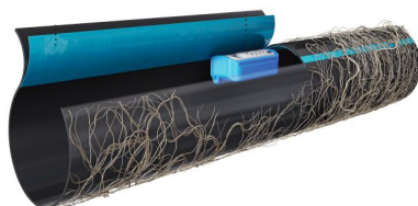
شکل 33- طرح واره‌ای یک قطره چکان برای محدود کردن نفوذ ریشه در سامانه آبیاری قطره‌ای زیرسطحی
