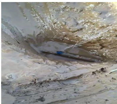
شکل 20- نمونه‌ای از مشکل صدمه دیدگی لوله آبدۀ در سامانه آبیاری قطره‌ای زیرسطحی (یوسف گمرکچی، 1399)
