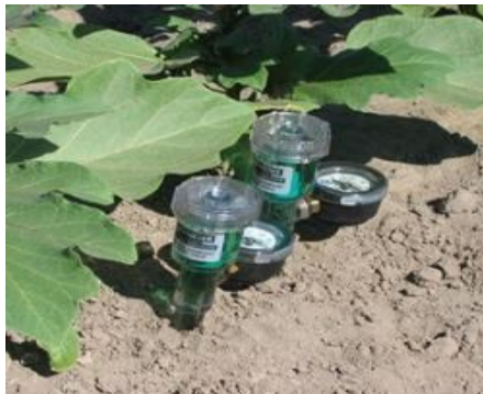
شکل 27- نمونه‌ای از نصب تانسایومتر برای پایش رطوبت خاک در یک مزرعه تحقیقاتی سامانه آبیاری قطره‌ای زیرسطحی (منبع، بی نام)
