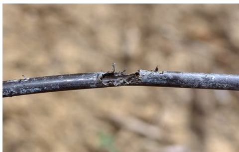
شکل 18- نمونه‌ای از آسیب جوندگان به لوله‌های آبد در سامانه آبیاری قطره‌ای زیرسطحی (ایرماک، 2010)
