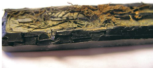
شکل 15- نمونه‌ای از تجمع ریشه در محل قطره چکان سامانه آبیاری قطره‌ای زیرسطحی (منبع، بی نام)
