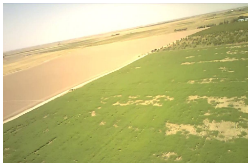
شکل 25- نمونه‌ای از خشک شدن خاک سطحی به صورت لکه‌ای و از بین رفتن محصول در یک سامانه آبیاری قطره‌ای زیرسطحی در منطقه بوئین زهرا (یوسف گمرکچی، 1398)
