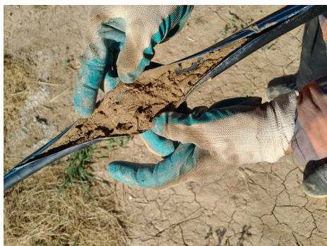
شکل 8- نمونه‌ای از مکش ذرات خاک به درون لوله آبدۀ در یک سامانه آبیاری قطره‌ای زیرسطحی در منطقه بوئین‌زهر (یوسف گمرکچی، 1397)
