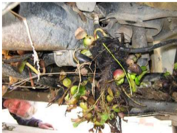
شکل ۱۶. بازدید زیر ماشین آلات جهت تمیز کردن بقایای گیاهی سنبل آبی (منبع: Harvey, 2013)
