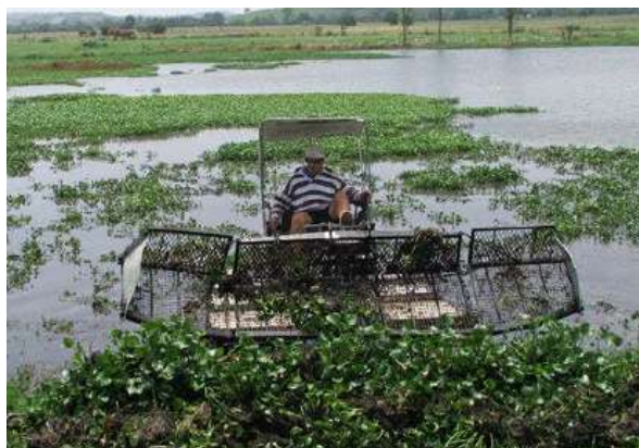
شکل ۲۲. کاربرد قایق مجهز به صفحات توری برای هدایت و جمع کردن توده‌های پراکنده سنبل آبی (منبع: Harvey, 2013)
